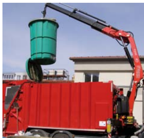
Vyprazdňování polopodzemního kontejneru
