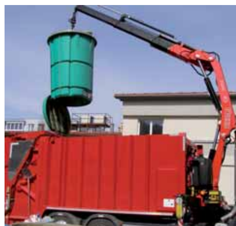
Опорожнение полуподземного контейнера
